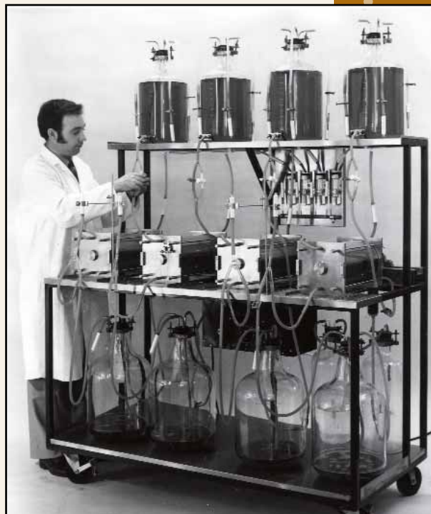
Le propagateur cellulaire multisurfaces, ou MSCP, était un appareil dans lequel des cellules rénales du singe étaient cultivées sur des disques de verre étroitement espacés, montés sur un arbre en acier tournant à l'intérieur d'un cylindre en verre. Pour maximiser la production du poliovirus, on utilisait plusieurs appareils MSCP à la fois, que l'on plaçait sur des chariots ambulants conçus à cet effet.
